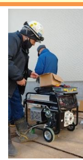
停電時には、LPG・ガソリン 兼用の自家発電機を活用し 薪ボイラー・ポンプの電源と 寮の最低限の電気・熱を自給可能に (環境省補助金の対象外)
